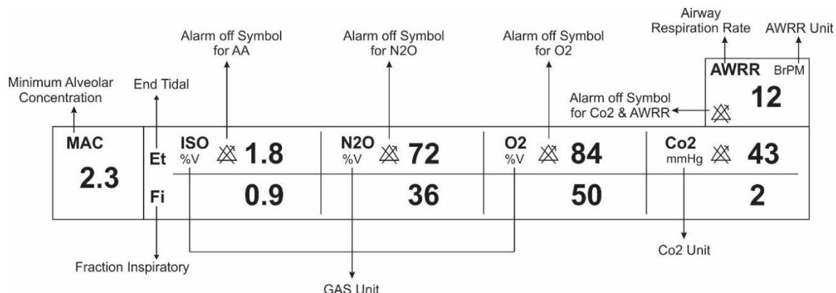
Figure 3-64 GAS parameter area using Multi-gas sensor
